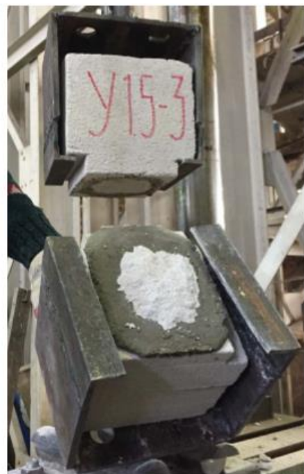
Рисунок 3 - Характер разрушения опытных образцов Figure 3 - Character of destruction of prototypes
