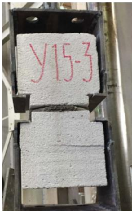
Рисунок 3 - Характер разрушения опытных образцов Figure 3 - Character of destruction of prototypes
